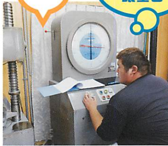
圧縮強度試験
